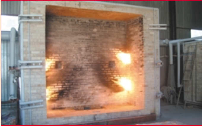
Проверка форсунок в печи для испытаний вертикальных судовых конструкций
