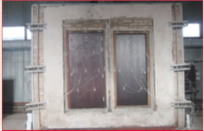
Противопожарные двери подготовлены к огневым испытаниям
