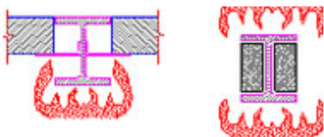
Рисунок 1.1-Воздействие огня на профильные сечения
